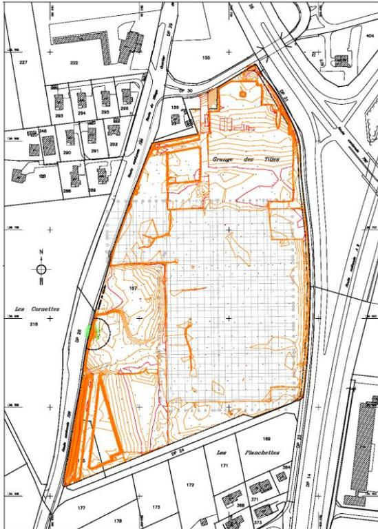
Un levé topographique de l'entier de la plate-forme a également été effectué, à titre de plan de recollement.
